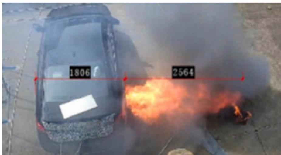
Рис. 1. Выброс пламени при возгорании литий-ионного аккумулятора электромобиля [9]
