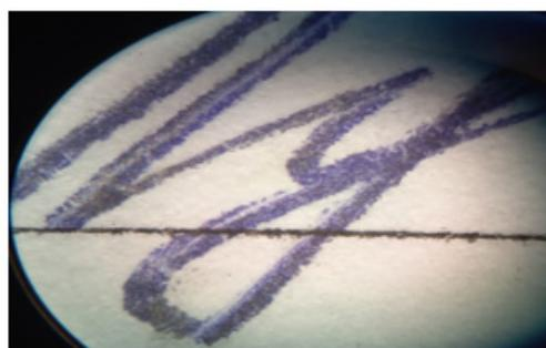
Рис. 7 Иллюстрация подписи и ее увеличенные фрагменты, нанесенные с помощью предварительной карандашной подготовки, с последующей обводкой ее контура пастой шариковой ручки.
