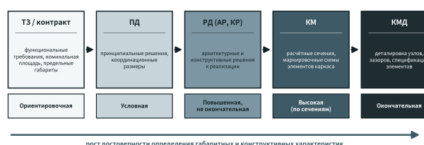
Рис. 3. Стадии разработки документации на БМЗ и достижимая достоверность экспертного определения габаритных и конструктивных характеристик
